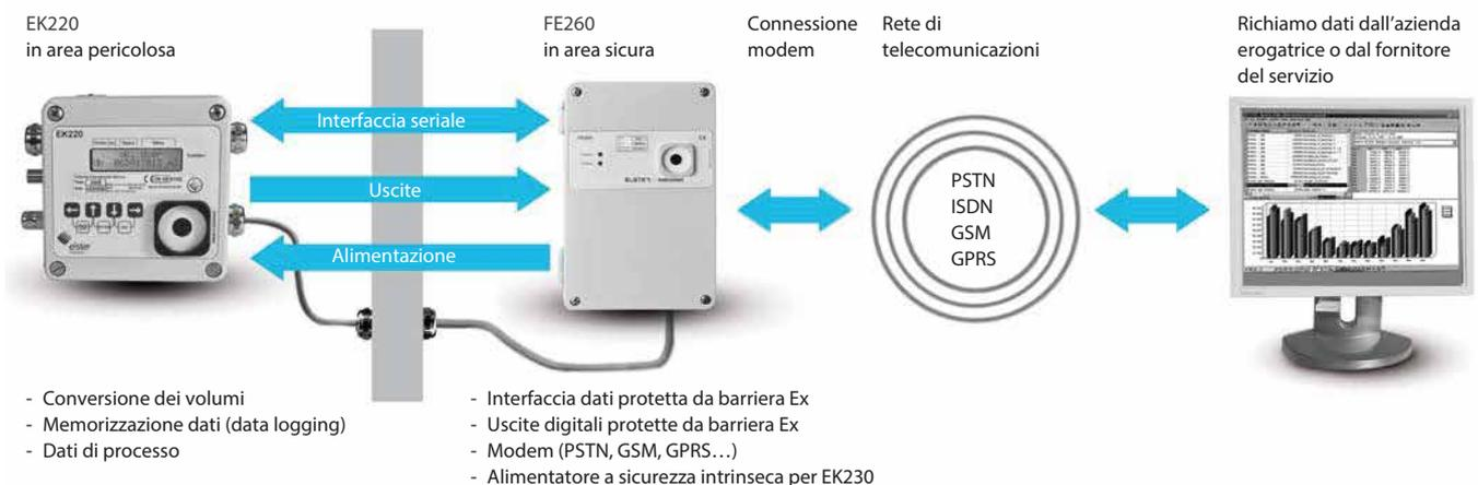
La barriera Ex per l'interfaccia seriale e le uscite per impulsi del convertitore di volumi è fornita dall'unità esterna FE260. Inoltre, è garantita l'alimentazione a sicurezza intrinseca del convertitore di volumi. La configurazione modulare dell'unità consente di utilizzare un modem per la trasmissione dati o un'interfaccia per il collegamento ad altri dispositivi.
